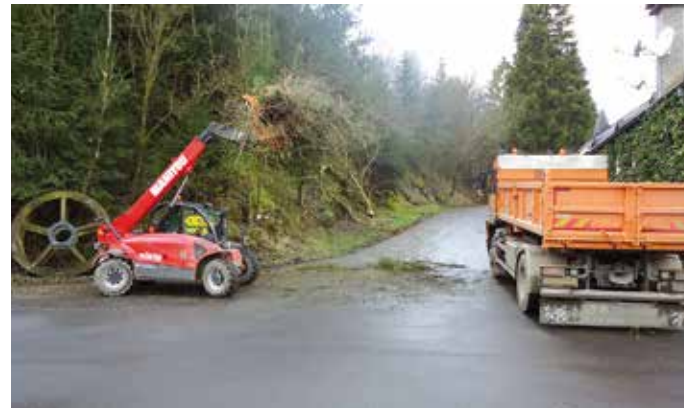
Eisen Gabelstapler «Manitou» ass equipiert matt enger Zang fir d'Hecken ze packen an op de Camion ze laaden. Virdrunner gouf alles matt der Hand an den Container geladen.
