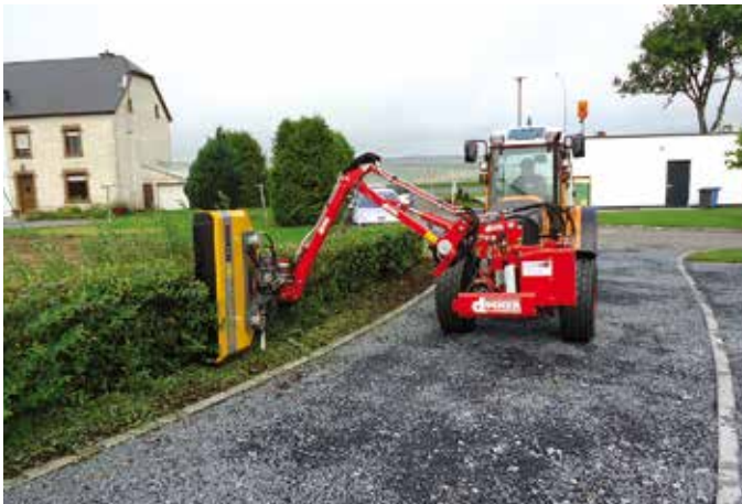
Matt deser moderner an vielseitiger Maschinn ass et meiglich Hecken an der Heicht an och seitlich propper ze schnegden.
