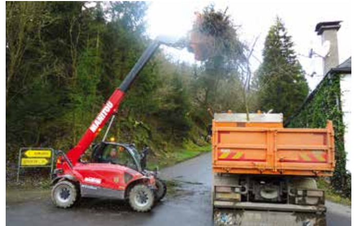
Eisen Gabelstapler «Manitou» ass equipiert matt enger Zang fir d'Hecken ze packen an op de Camion ze laaden. Virdrunner gouf alles matt der Hand an den Container geladen.
